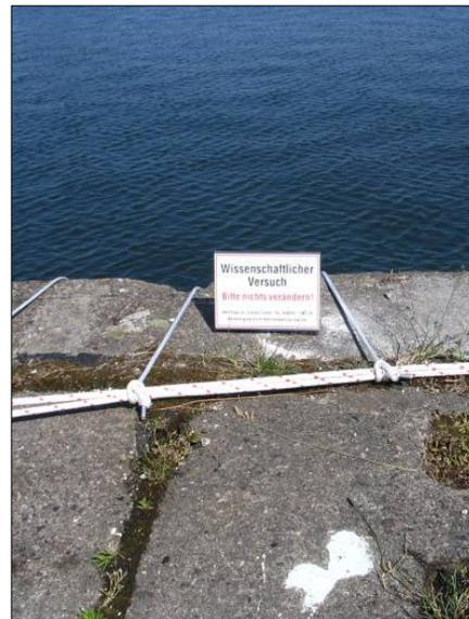
**Abb.9:** Befestigung der Gitterrahmen-Leinen an einer mit Dübeln in der Kaimauer verankerten Querleine
