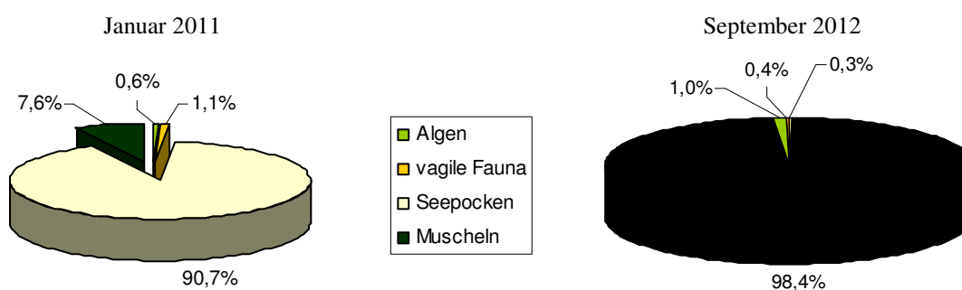
Abb.3.2.3-3: Prozentuale Anteile der Hauptbewuchsgruppen am Gesamtbewuchs (bezogen auf Trockengewicht) im Januar 2011 und im September 2012
